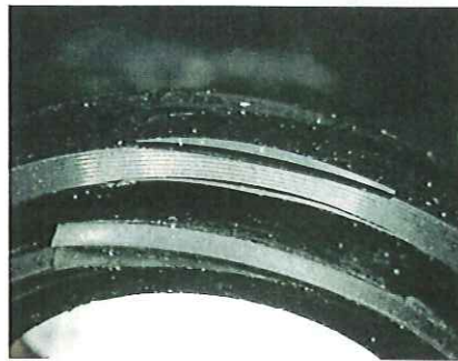
Bild 1. Schadensbeispiel 1: Ausfall durch Verunreinigung der Mischung, Compoundfehler (LIM, Detailaufnahme)
